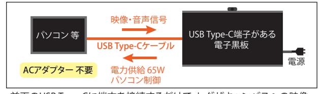
前面のUSB Type-Cに端末を接続するだけで、レグザキャンパスへの映像・音声データ送信と、レグザキャンパスからの給電がケーブル1本で可能
